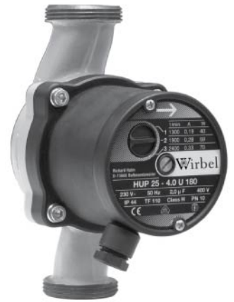
Обозначение HUP 25 - 2,5 U 180 Циркуляционный насос Условный проход Максимальный напор Н [м] Регулирование количества оборотов Монтажная длина в [мм]
